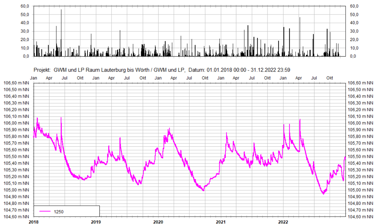
Abb. 14: Grundwasserstände der Messstelle 1250 von 01.01.2018 bis 31.12.2022 mit der Tagesniederschlagsverteilung der Wetterstation Büchelberg bei Wörth am Rhein
