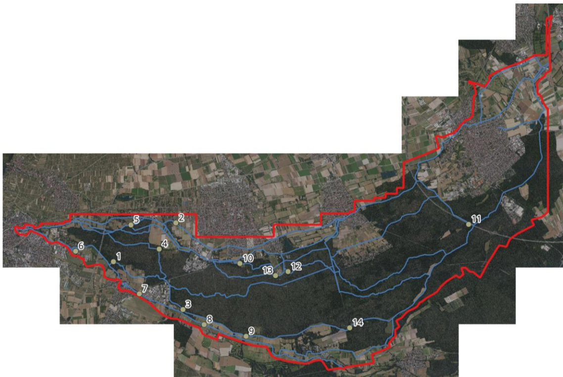
Abbildung 22: Lage der Regulierbauwerke im Gewässersystem des Rehbach-Speyerbach-Schwemmfächers
