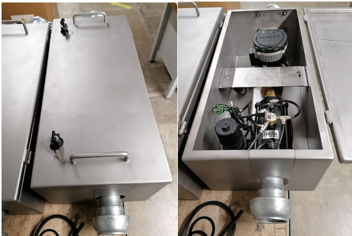
Abb. 14 Transportable Messbox (Edelstahlgehäuse), Quelle: Ralph Scheyer, Hessisches Ministerium für Umwelt, Klimaschutz, Landwirtschaft und Verbraucherschutz; Optimierte Wasserbereitstellung durch ein Online-Wasserzählsystem; Mülheimer Tagung 2022; Mülheim (03.03.2022)
