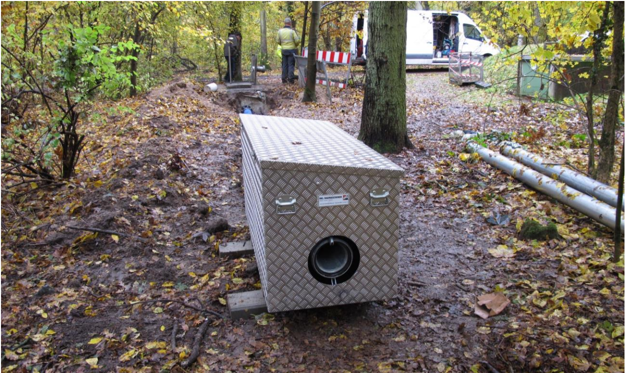
Abb. 12 Projekt SiZuRi - Aluminium-Kiste zum Schutz der Messeinrichtung; Quelle: BGS UMWELT (2021)
