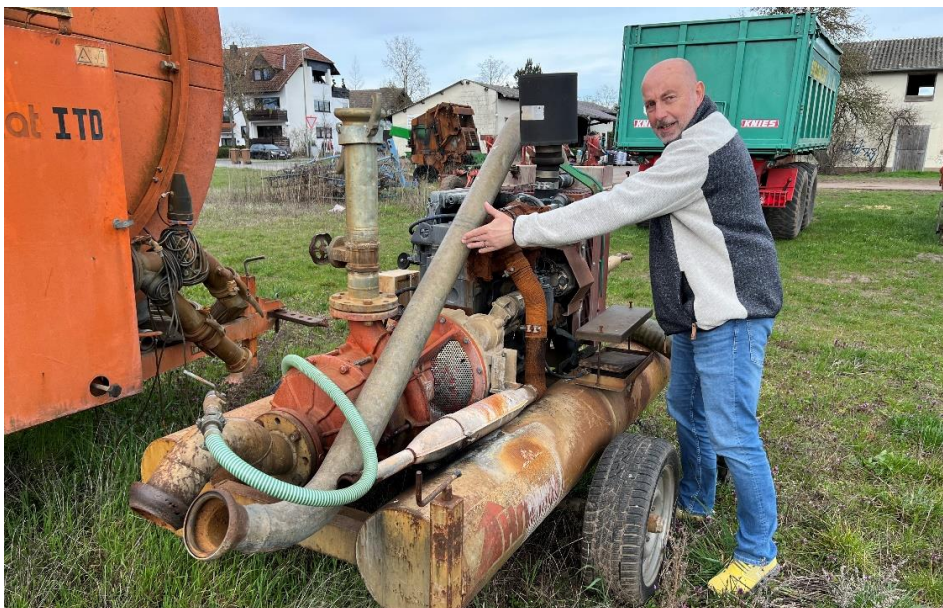
Abb. 5 Pumpaggregat der Fa. Hofmann älterer Bauart ohne Steuermodul bei Nauheim (2023)
