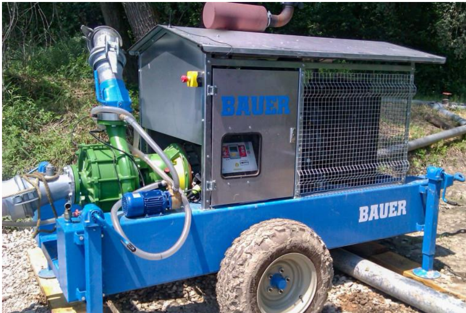
Abb. 4 Pumpenaggregat der Fa. Bauer mit integriertem Steuermodul (mittig im Bild); Quelle: https://www.bauer-at.com/wp-content/uploads/Dieselpumpaggregat2-768x512.jpg (02.05.2024)
