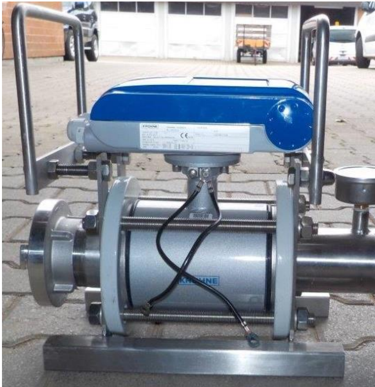
Abb. 10 Magnetisch-induktiver Durchflussmesser mit Tragegestell
