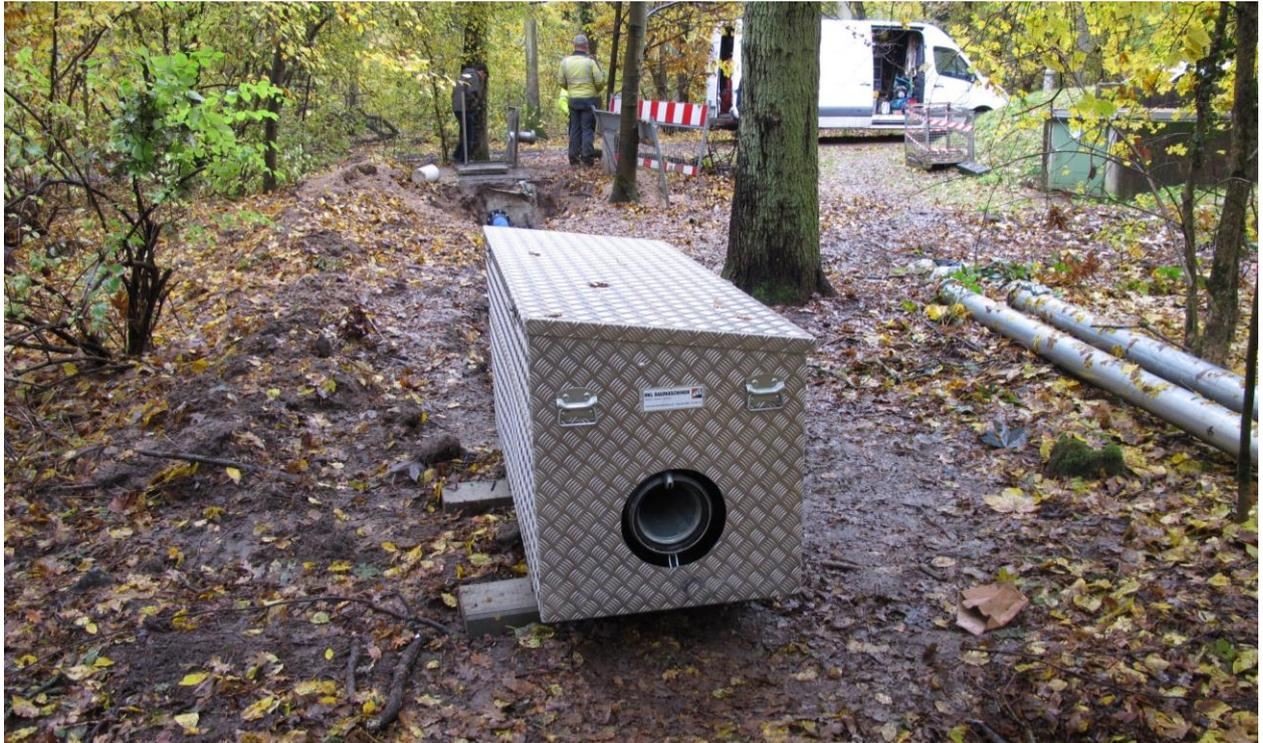
Abb. 12 Projekt SiZuRi - Aluminium-Kiste zum Schutz der Messeinrichtung; Quelle: BGS UMWELT (2021)
