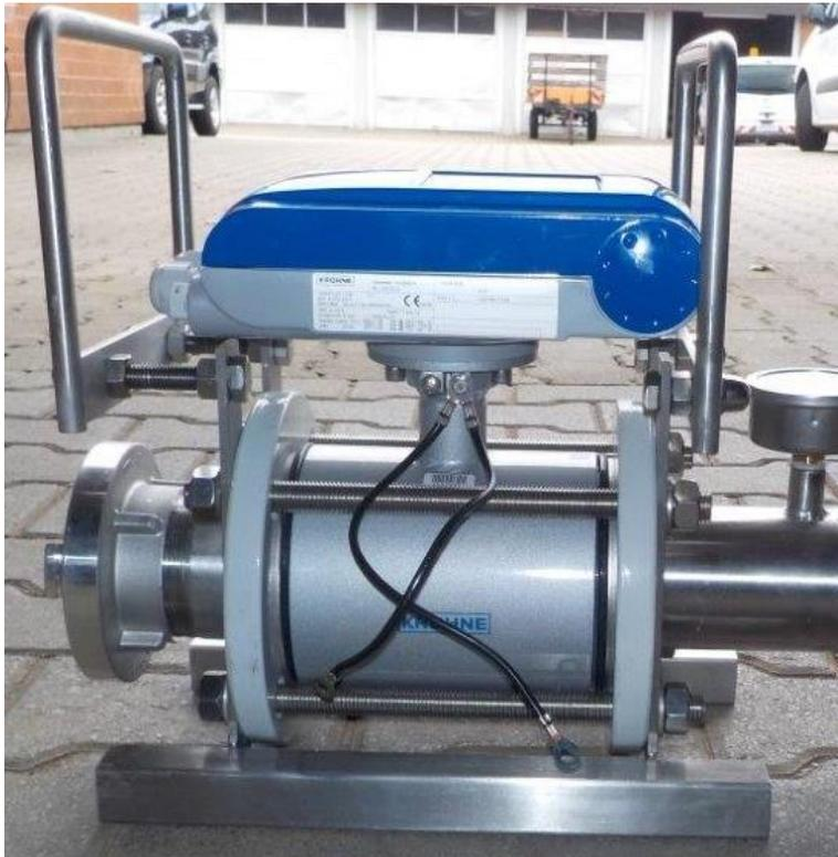
Abb. 10 Magnetisch-induktiver Durchflussmesser mit Tragegestell
